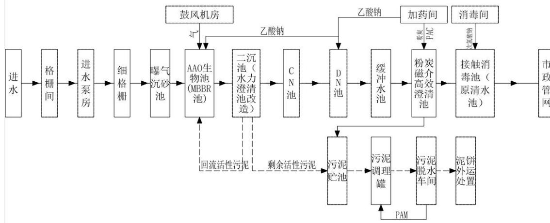
图 4-1 污水处理工艺流程示意图
