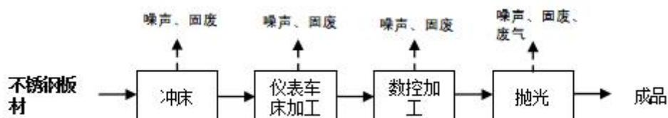
图 2-2 项目生产工艺流程及产污环节示意图
