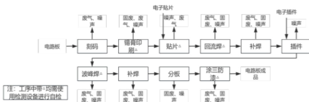
图 2-4 项目电路板生产工艺流程及产污环节示意图
