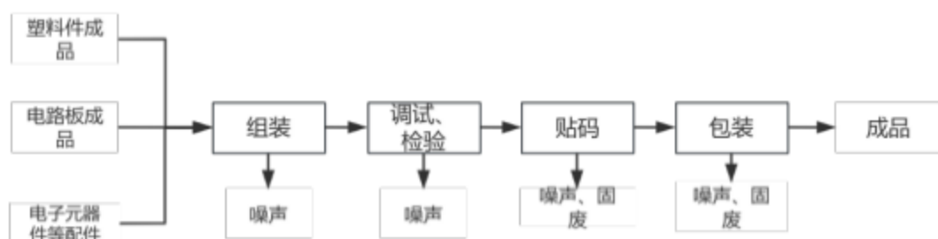
图 2-6 项目智能电表生产工艺流程及产污环节示意图
