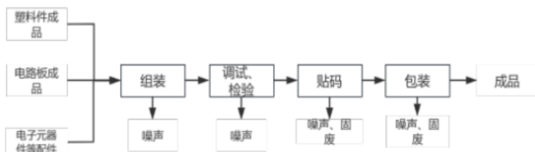
图 2-9 项目配电智能网关生产工艺流程及产污环节示意图
