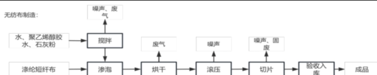
图 2-3 现有项目无纺布生产工艺流程及产污环节示意图
