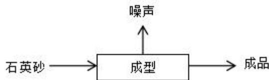
图 2-4 项目卫浴模具生产工艺流程及产污环节示意图
