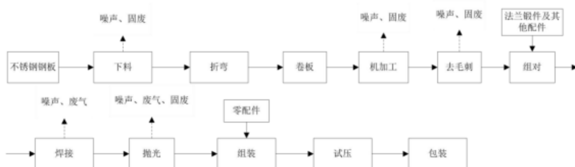
图 2-2 A厂区已审批生产工艺流程图
