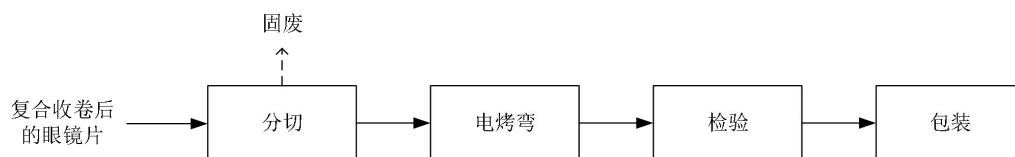
图 2-4 项目产品包装工艺流程及产污节点示意图
