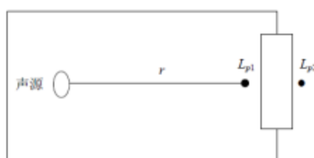
图 4-3 室内声源等效为室外声源示意图
