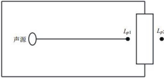
图 4-3 室内声源等效为室外声源示意图
