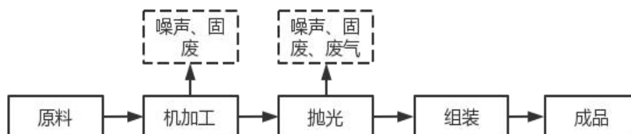
图 2-4 卫浴配件生产工艺流程及产污环节示意图
