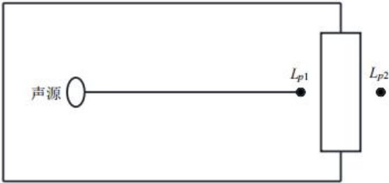
图 4-2 室内声源等效为室外声源示意图
