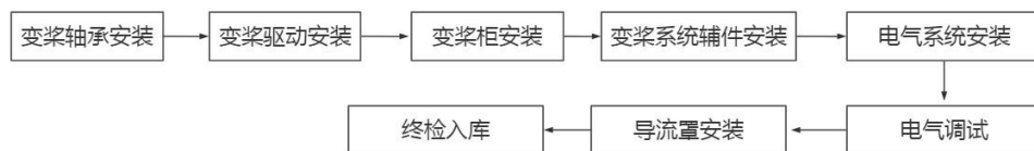
图 2-3 风电轮毂工艺流程图
