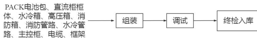
图 2-4 储能直流柜生产工艺流程及产污节点示意图
