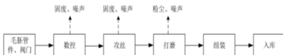
图 2-4 原有项目生产工艺流程及产污节点示意图
