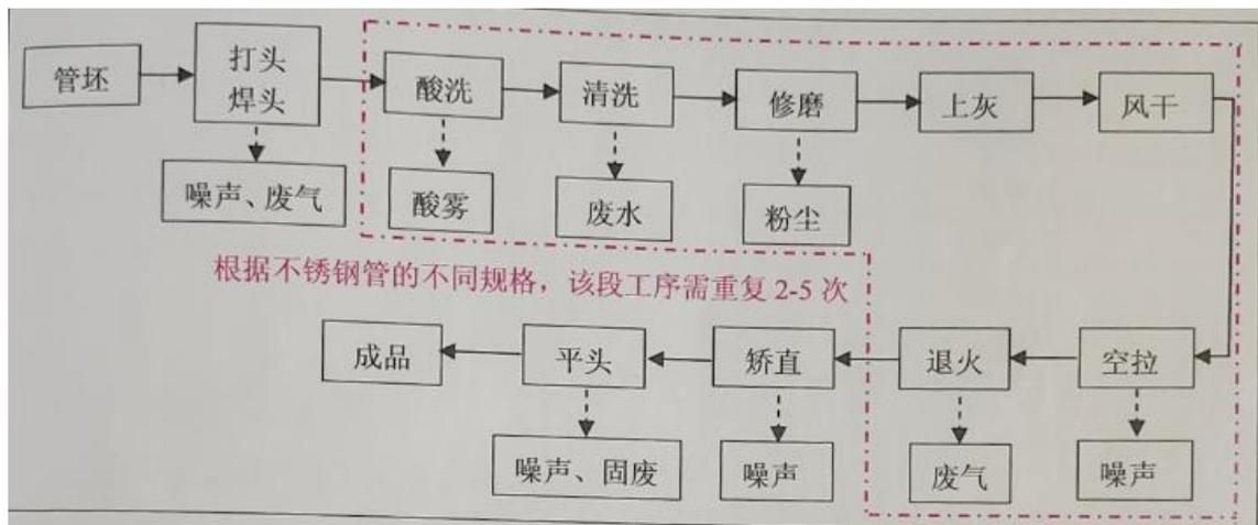
图 2-5 原有项目工艺流程及产污环节示意图
