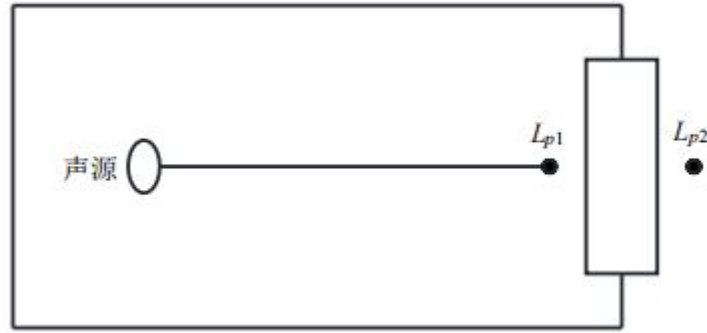
图 4-2 室内声源等效为室外声源示意图
